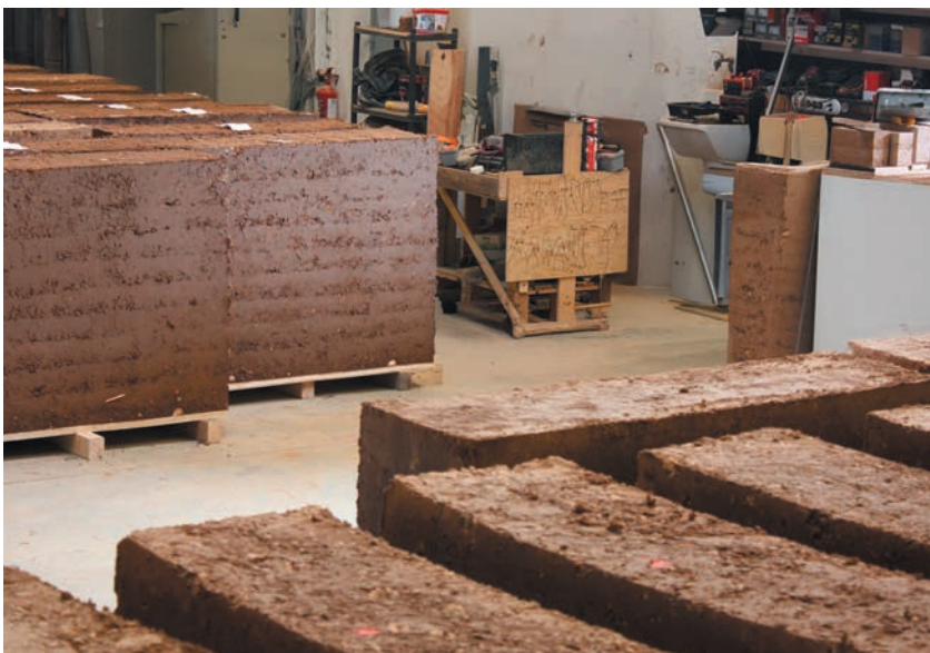
Atelier de la start-up Terrio qui fabrique des matériaux en terre crue pour la construction.
